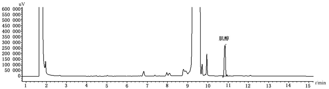
图 A.2 肌醇试样衍生物气相色谱图
