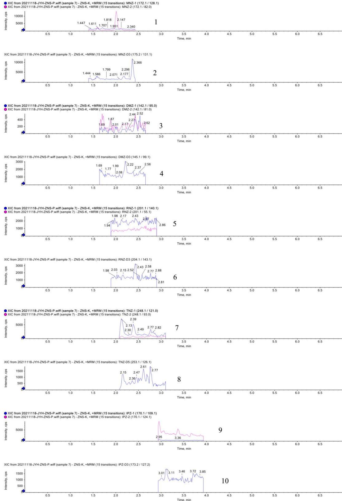
图 25 饲料（牛精料补充料）中空白样品特征离子质量色谱图 （1.甲硝唑 2.甲硝唑-d3 3.地美硝唑 4.地美硝唑-d3 5.洛硝达唑 6.洛硝达唑-d3 7.替硝唑 8.替硝唑-d5 9.异丙硝唑 10.异丙硝唑-d3）
