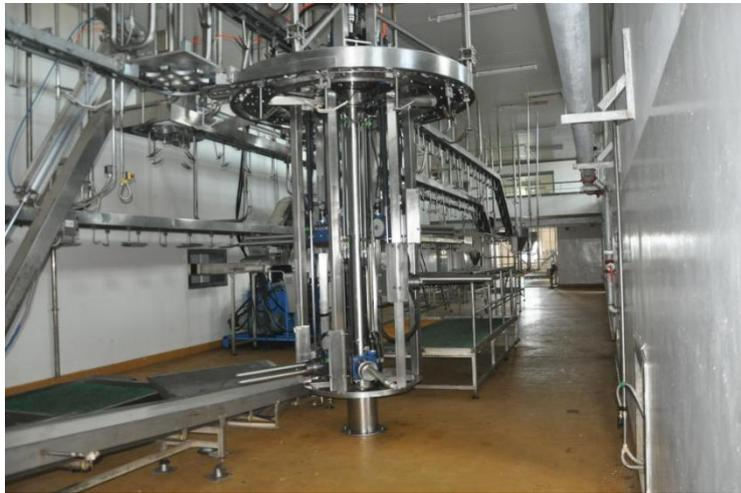
图 A.2 羊多工位剥皮机（卷皮式）
