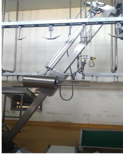
图 A.1 羊倾斜式剥皮机（卷皮式）
