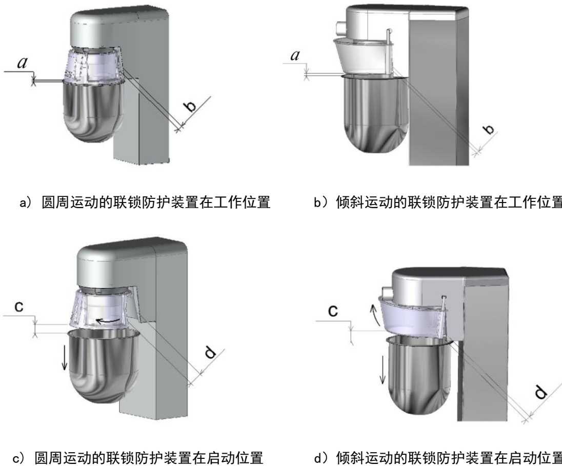
图4 不同类型防护装置的安全尺寸
