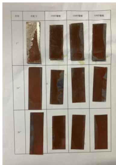
马口铁在不同配方溶液浸泡后对比
