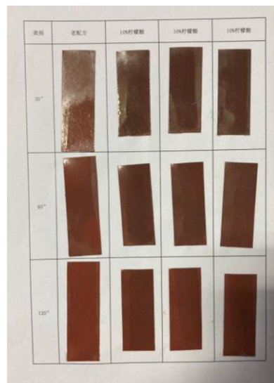
马口铁在不同配方溶液浸泡后对比
