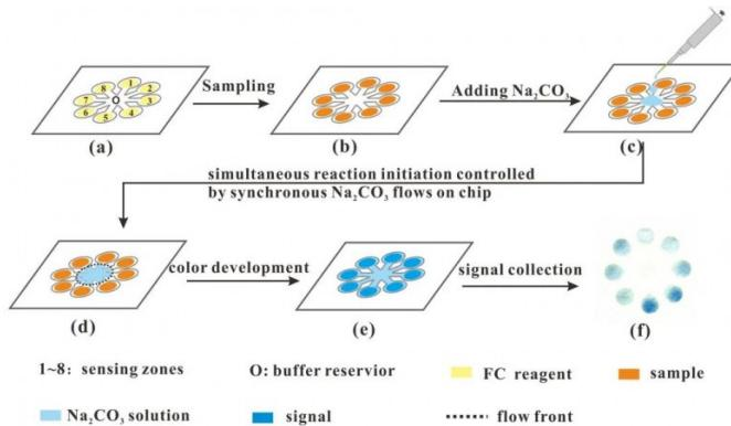
据团队首席鲁成银研究员介绍，茶多酚是决定茶叶滋味及保健功效的主要成分。传统茶多酚含量测定以福林酚显色反应为基础，但由于福林酚试剂与茶多酚的反应本身非常缓慢，需要2小时左右才能达到稳定状态，因而传统茶多酚含量检测方法存在操作复杂、耗时、试剂消耗大以及成本高等缺陷。该团队研发的微流控纸芯片技术具有高通量液流操控的特殊功能，可实现对平行反应的精确控制，结合动力学匹配方法，在10分钟内即可完成茶多酚含量的准确测定。与传统方法相比，该方法在显著缩短检测时间的同时，还具有节约试剂、装置简单的优势，在茶叶生产实时监控、消费者自测等方面具有良好的应用前景。
