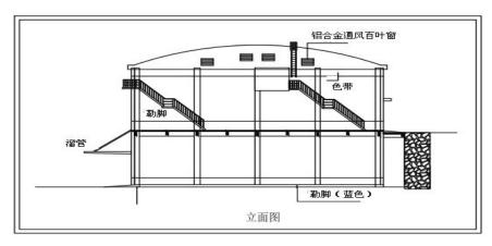
该仓型第一层楼房仓向一侧开门,第二层的楼房仓则向另一侧开门,且第二层楼房仓可安装溜管,通过高差实现粮食自溜装车。
