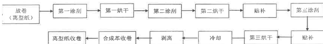
图 33-4 聚氨酯干法工艺生产工艺流程图
