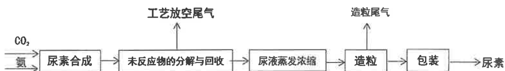
图 25-5 尿素生产工艺流程图
